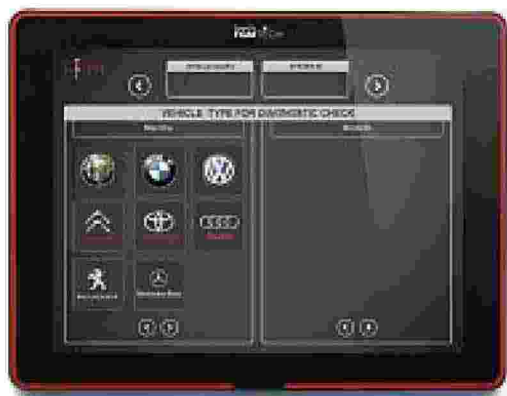
La schermata che compare sul kit Diogene al momento di analizzare le centraline (possono essere anche più di 50) e verificare con precisione gli effettivi chilometri percorsi dalla vettura usata che si ha intenzione di acquistare
